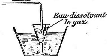
FIG. 67. — PRÉPARATION DE LA DISSOLUTION D'ACIDE CHLORHYDRIQUE.
