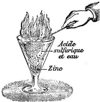
FIG. 22. — PRÉPARATION RAPIDE DE L'HYDROGÈNE.
