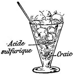
FIG. 89. — DÉGAGEMENT DE GAZ CARBONIQUE quand on fait agir un acide sur un carbonate (craie).
