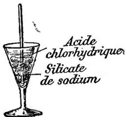
FIG. 102. — FORMATION DE SILICE GÉLATINEUSE en faisant agir de l'acide chlorhydrique sur du silicate de sodium.
