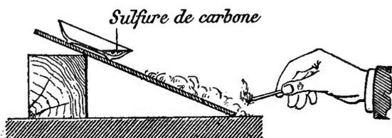
FIG. 101. — LES VAPEURS LOURDES DE SULFURE DE CARBONE S'ENFLAMMENT A DISTANCE : *Vapeurs coulant sur une planche et prenant feu à 25 ou 30 centimètres de la soucoupe d'où elles proviennent.*
