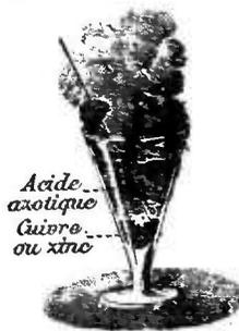
FIG. 58. — ATTAQUE D'UN MÉTAL (cuivre, zinc, etc.) PAR L'ACIDE AZOTIQUE. Formation de vapeurs rutilantes.
