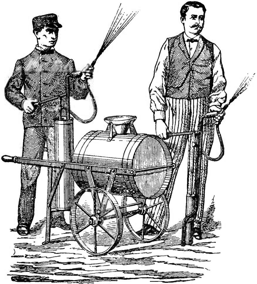
Fig. 300. — Tonneau arroseur et pompe à main Dudon.
