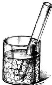
On verse de l'eau dans un tube en verre mince qu'on plonge dans un mélange réfrigérant; au bout de quelques minutes, l'eau s'est transformée en un cylindre de glace qu'on peut retirer en tenant le tube quelque temps dans la main pour fondre l'enveloppe extérieure de la glace.
