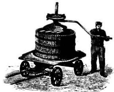
FIG. 534. — Le pressoir. — Lorsque le vin est tiré, on porte le marc au pressoir afin d'en extraire le reste du liquide. Le marc est alors repris avec de l'eau et distillé pour donner de l'eau-de-vie, dite eau-de-vie de marc.
