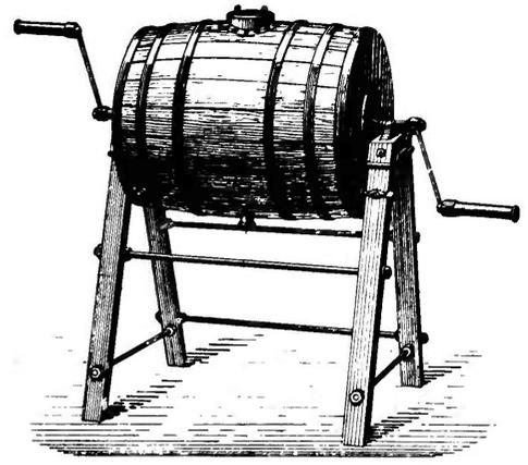
Fig. 353. — *Baratte mobile*. — Dans la *baratte mobile*, le mouvement de rotation est imprimé au tonneau tout entier qui est supporté à ses extrémités par des tourillons, dont l'un constitue la manivelle.
