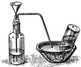
**Préparation de l'acide carbonique.** — On a un flacon à deux tubulures plein d'eau ; on y jette des fragments de marbre ; par le tube à entonnoir, on verse de l'acide chlorhydrique. L'effervescence
