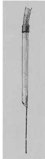
Fig. 74. — Ose montée sur tube creux pour l'ensemencement des cultures anaérobies.
