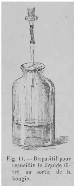
Fig. 11. — Dispositif pour recueillir le liquide filtré au sortir de la bougie.
