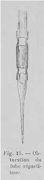
Fig. 15. — Obturation du tube répartiteur.
