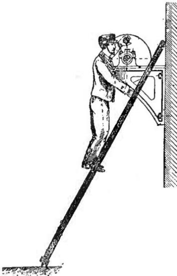
Fig. 124. — Echelle avec pointes sur sol en terre. (Position dangereuse pour l'ouvrier). (Thureau).
