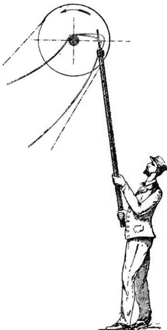
Fig. 130. — Maniement de la perche à crochet. — Perche trop courte, dangereuse pour l'ouvrier.
