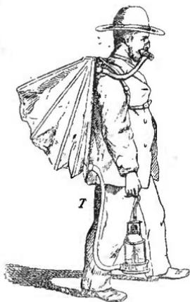
Fig. 106. — Sauveteur muni du respirateur Fayol.
