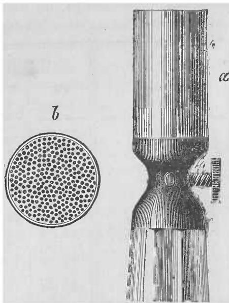
Électrode pour l'examen faradocutané de la sensibilité. — A. Tuyaux de caoutchouc. B. surface libre de l'électrode.
