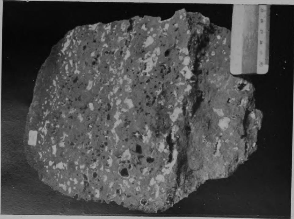
FOTOGRAFIA 7 — Basalto da barragem da Empresa de Eletricidade Vate Parapanema S. A., proximidades de Assis, São Paulo. Notar a distribuição linear das amígdalas. Os minerais d. - preenchimento dominantes são a ptílolita e a heulandita.
