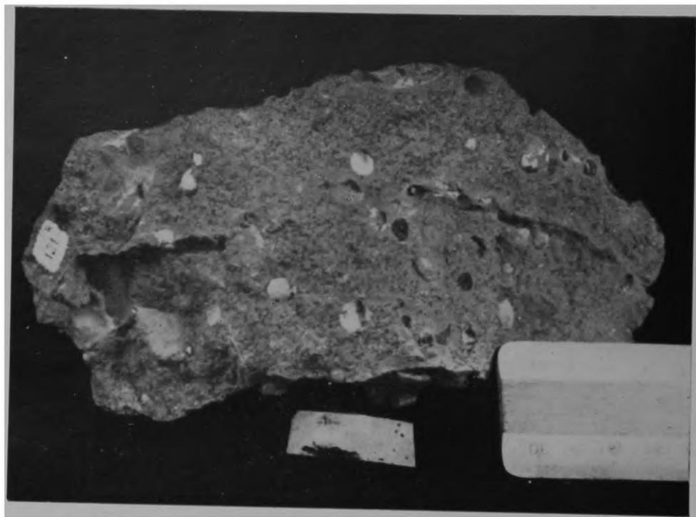
FOTOGRAFIA 3 — Basalto da barragem da Empresa de Eletricidade Vale do Paranapanema S. A., proximidades de Assis, São Paulo. Notar vesículas preenchidas por calcedônia (material claro) e daphnita (material escuro).
