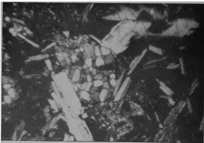
FOTOMICROGRAFIA 6 — Córrego da Manga, Mato Grosso. Fragmento globóide de arenito no interior do basalto rico de mesostasis vítrea. Compare com Fig. 12, no texto. 25 x — Nícois cruzados.
