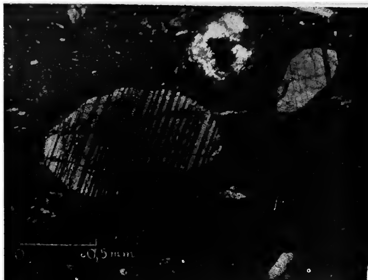
Fotomicrografia 7 — Xenocristais de plagioclásio mergulhados no corpo da rocha Pv (b).
