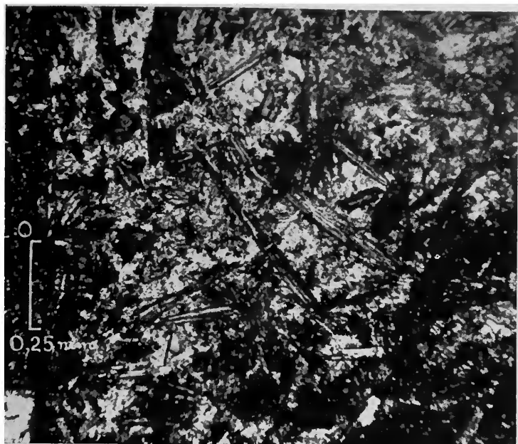
Fotomicrografia 5 — (Nícois paralelos-90x) — Zona diferenciada descrita no texto, onde são observados cristais bem desenvolvidos de biotita e de titanita e a base (em branco) constituída de analcita.
