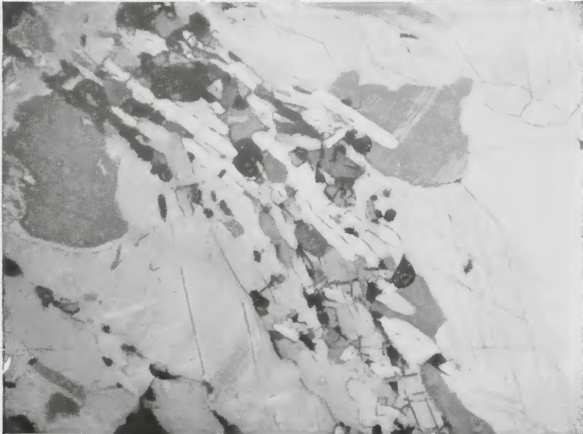
Fotografia 10 — Carbonatito com apatita em agregado de prismas paralelos. Nicois cruzados, aumento 20 vêzes.
